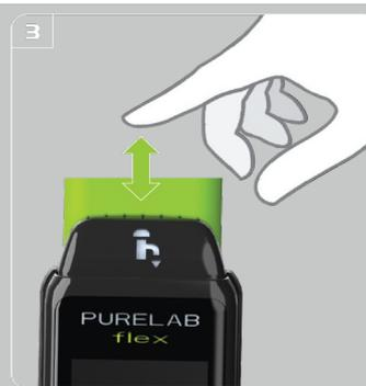
DRÜCKEN Sie die Dosiertaste, um die voreingestellte Menge zu dosieren.
